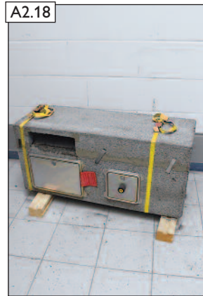
Fertigansicht nach dem Verspachteln.
